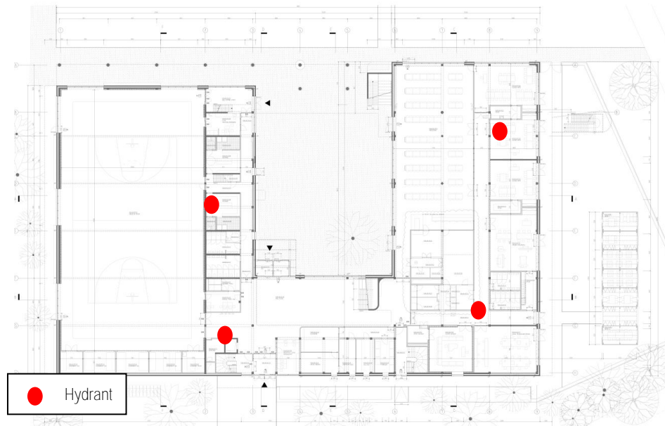
Figure 149 : Localisation des hydrants de l'école DOA (exemple du rez-de-chaussée) (ARIES sur fond V+, 2018)
