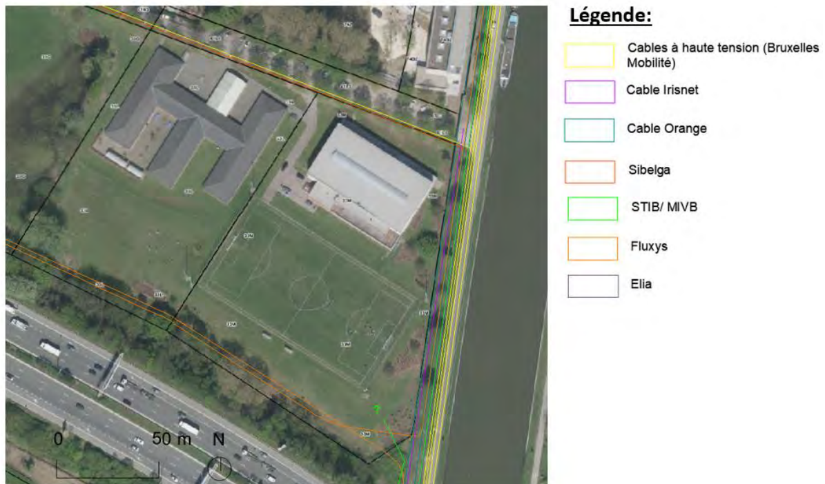
Figure 172 : Superposition (par ARIES) des plans fournis par les gestionnaires de réseau (en arrière-plan : photo aérienne et plan cadastral selon BruGIS)
