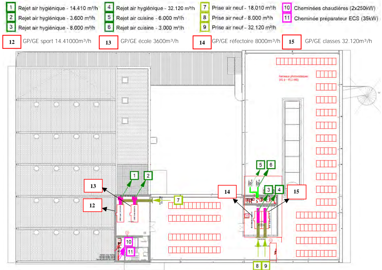
Figure 214: Localisation des groupes de ventilation et équipements du bâtiment DOA en toiture (ARIES sur fond MK Engineering, 2018)
